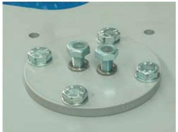
*POSITIONNER LE GROUPE ETOILE-MOYEU SUR L'ARBRE MOTEUR ET SERRER
