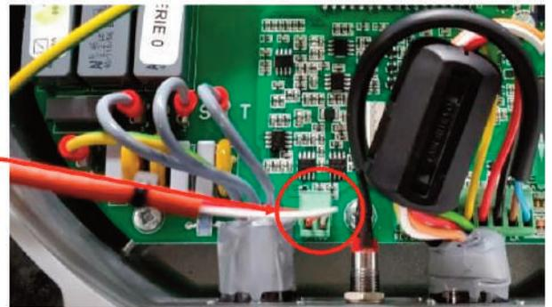
*INSÉRER LE CONNECTEUR VERT, AVEC LES FILS BLANC/ROUGE, DU CAPTEUR DE TEMPÉRATURE DU MOTEUR DANS LE CONNECTEUR SPÉCIAL DE L'ÉLECTRONIQUE (TEL QUE POSITIONNÉ SUR LA FIGURE).*
